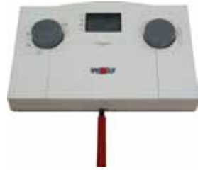
Demontage van de ART van het voetstuk d.m.v. een schroevendraaier
